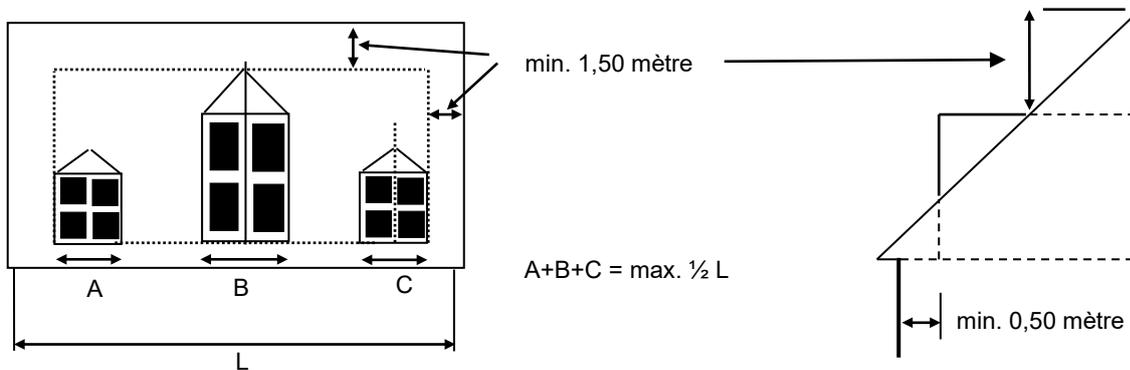
La largeur des lucarnes dans le Secteur protégé de type «environnement construit – C » devra être inférieure à celle des ouvertures de fenêtres situés en dessous dans la façade concernée, afin de préserver une harmonie sur l’ensemble de la façade.
